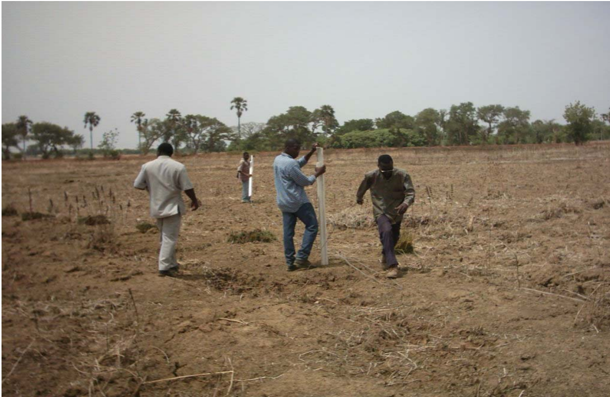
Photo 1 : Techniciens effectuant le profil en long d'un bas-fond au niveau à eau (PRP)
