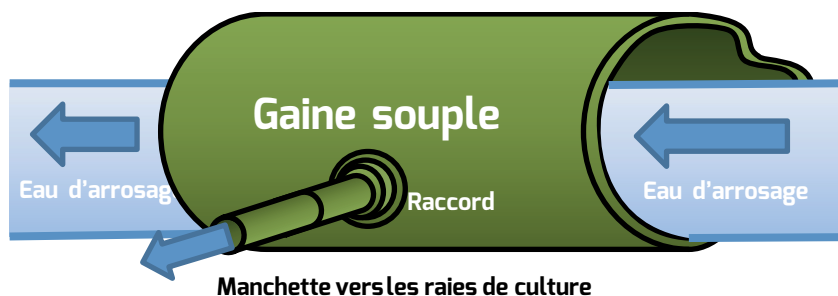
Figure 5. Elaboration propre, 2016. «Manchette attaché à une gaine souple d'arrosage».
